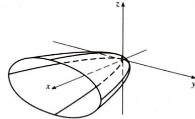
13. Cone elíptico com eixo no eixo  $x$
